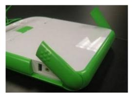
La pantalla de la computadora portátil y el teclado están conectados mediante una bisagra. Debes levantar la pantalla y sujetar el teclado para abrir la computadora.
