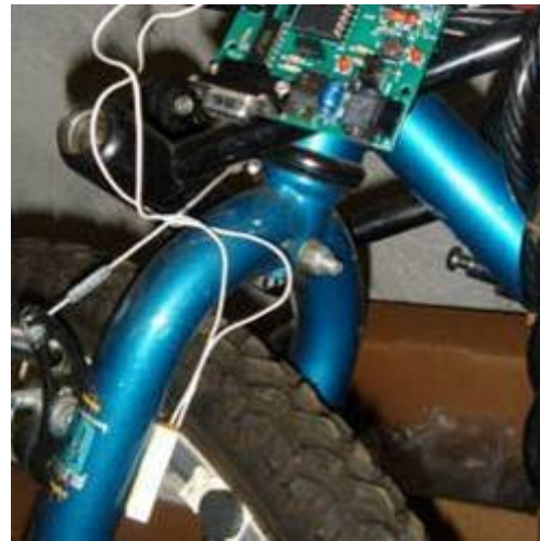
Figura 8. Sensor magnético instalado en la bicicleta
