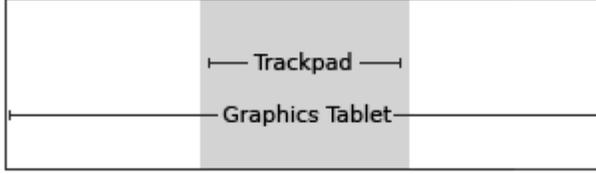
يمكن استخدام الجزء الأوسط من لوحة الرسم – والمسمى بلوحة الماوس (المنطقة المظللة باللون الرمادي في الصورة) – كجهاز للإشارة. قم بتحريك إصبعك حول لوحة الماوس لتحريك المؤشر. كما يمكن استخدام سطح لوحة الرسم بالكامل مع قلم للتأشير (الكتابة) على اللوحة.
