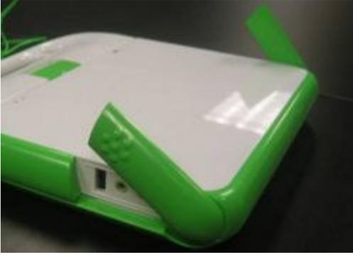
تتصل شاشة الحاسوب المحمول بلوحة المفاتيح بمفصلة. ارفع شاشة الحاسوب المحمول إلى أعلى مع الإبقاء على لوحة المفاتيح بالأسفل ليتم الفتح.
