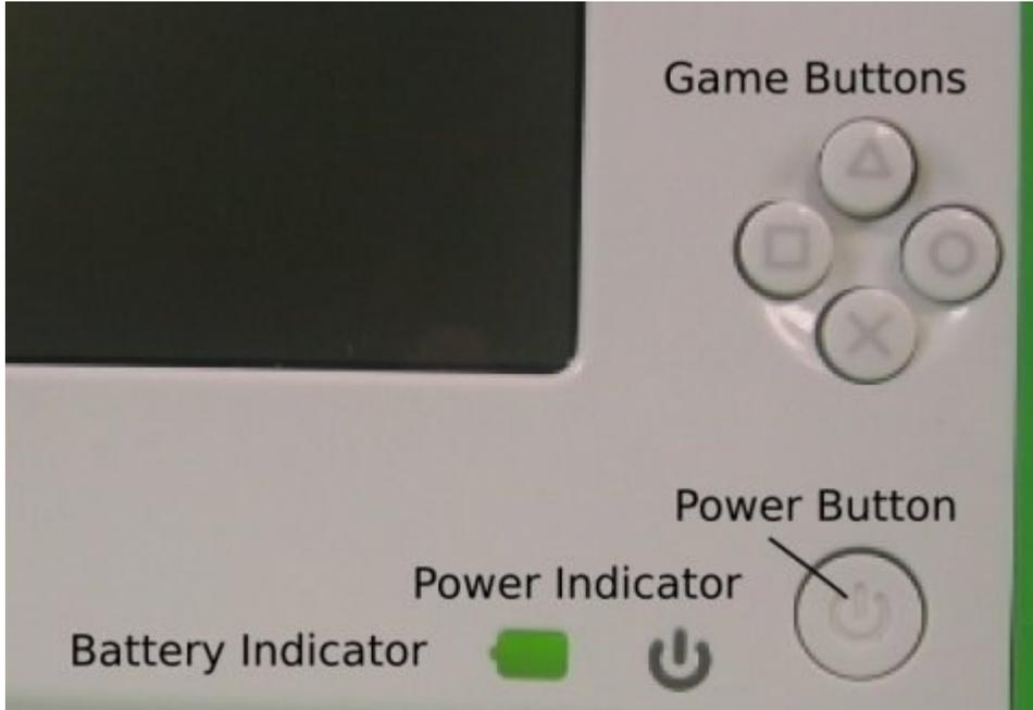
يوجد زر التشغيل في الركن الأيمن السفلي من الجزء المحيط بالشاشة. اضغط على زر التشغيل لتشغيل الحاسوب المحمول. سوف يضيء مؤشر LED الأخضر الخاص بالطاقة فور التشغيل. إلا أن الحاسوب المحمول يستغرق دقيقتين تقريباً ليقوم بعملية التمهيد.
